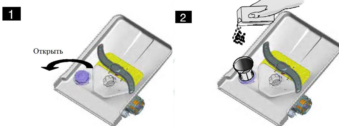
**А** Снимите нижнюю корзину, затем выкрутите и снимите крышку контейнера для соли. **1**
