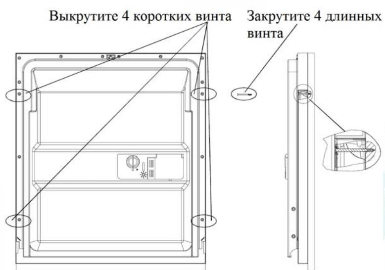
• **Регулировка упругости пружины дверцы посудомоечной машины**
