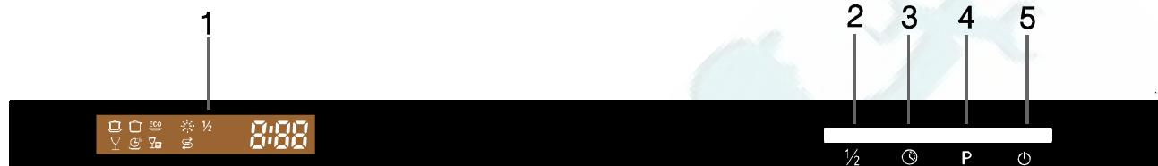
1. Окно дисплея: показывает выбранную программу, уровень соли и ополаскивателя, время задержки начала мойки, коды ошибок и т.д.
